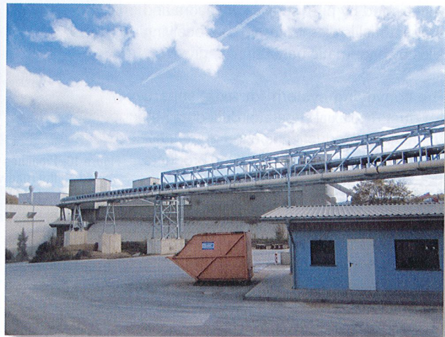
Figure 9: View of the tube belt conveyor on the lattice bridge with the pipeline underneath it Bild 9: Rohrgurtförderer auf der Fachwerkbrücke und unten verlagerte Förderrohrleitung
